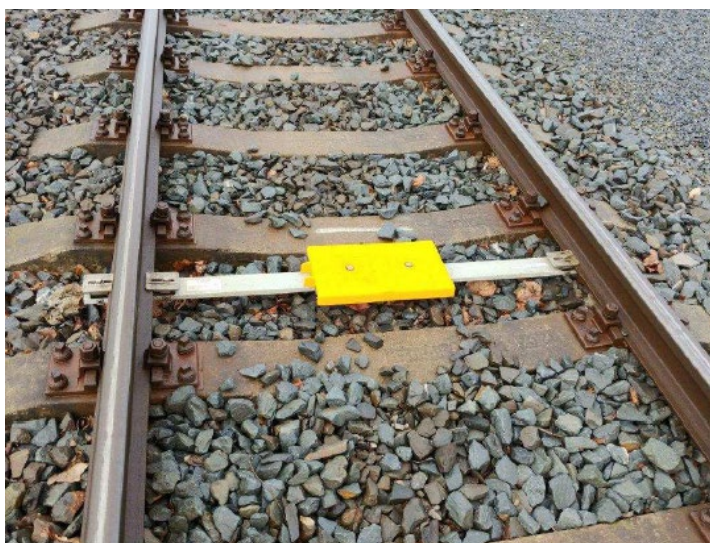
Obrázek č.1 –Balíza systému ETCS
